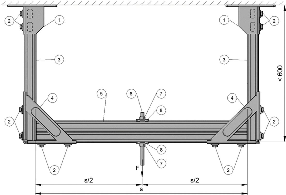
Estructura trapezoidal con  $s = 700$  mm,  $1000$  mm,  $1250$  mm y conexión céntrica para la introducción de cargas.
