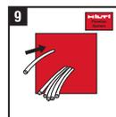
**9** **Instalación posterior de cables o tuberías** Una vez sellada la discontinuidad es posible la nueva instalación de cables o tuberías adicionales sin dificultad. No sobrepase el número ni las dimensiones máximos de cables o tuberías homologados.
