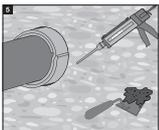
Selle el hueco entre la venda y el material base con yeso o Espuma Intumescente Hilti (véanse los detalles de la ETA 10/109 para Espuma CFS-F FX FS).
