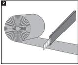
Corte la Venda Intumescente Hilti CFS-B para ajustarla al diámetro exterior del aislante. Asegure longitud suficiente para que al enrollar la venda, de dos vueltas sobre la tubería, una capa sobre otra.
