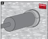
Si fuera necesario, deberá instalarse un aislante adicional sobre la venda. Monte la placa de identificación de la instalación junto a la abertura correctamente sellada si así se exigiera.
