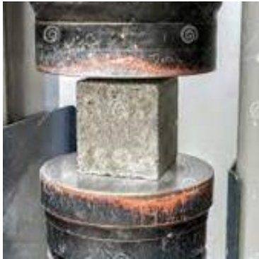
Rotura de probetas por el método tradicional
