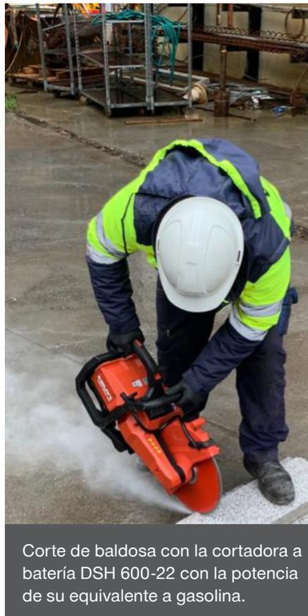
Corte de baldosa con la cortadora a batería DSH 600-22 con la potencia de su equivalente a gasolina.
