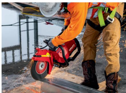
Las cortadoras DSH cortan tanto con disco de diamante como con disco abrasivo.
