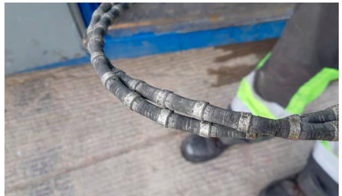
El hilo de Hilti VB está diseñado para alcanzar un gran rendimiento en acero, con caucho reforzado.
