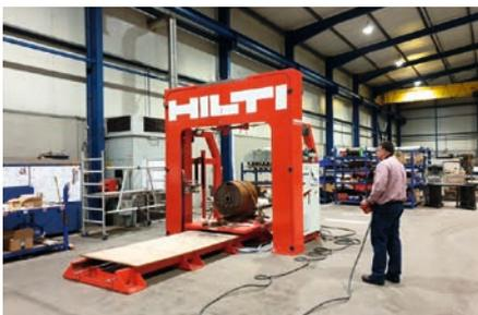
Corte de tuberías en empresa química con un portal con circuito de hilo de diamante.
