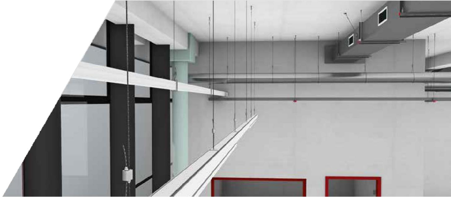
**HVAC: conducto rectangular con columpio**
