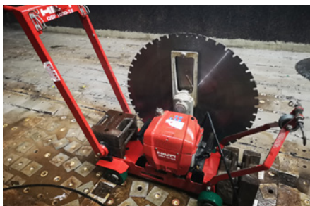
Corte de suelo con la cabeza DST 10-CA con disco de 800 mm de diámetro sobre el carro ligero.
