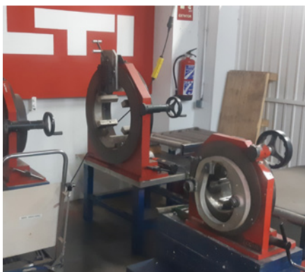
Cabezales de corte para cortar y sanear los tubos antes de soldar los segmentos.
