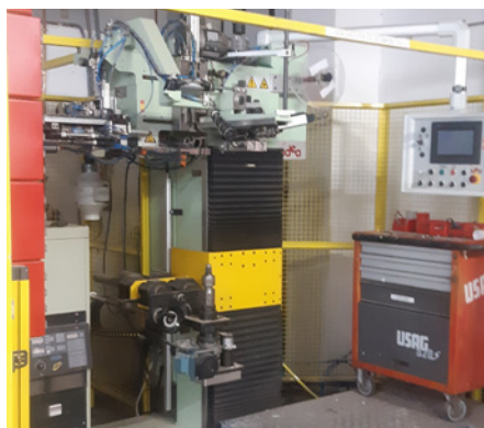
Hilti reempastilla en su taller de Alcalá de Henares con máquina de soldar o manualmente.
