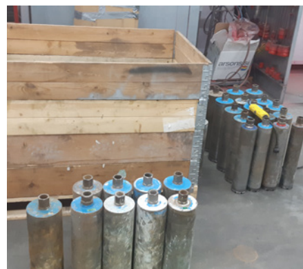
El reempastillado segmento a segmento es un sistema popular por aprovechar tubos en buen estado a buen precio.
