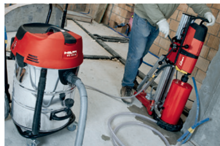
Máximo rendimiento: aspirador de agua Hilti VC 60 conectado a la potente perforadora de diamante DD 350.
