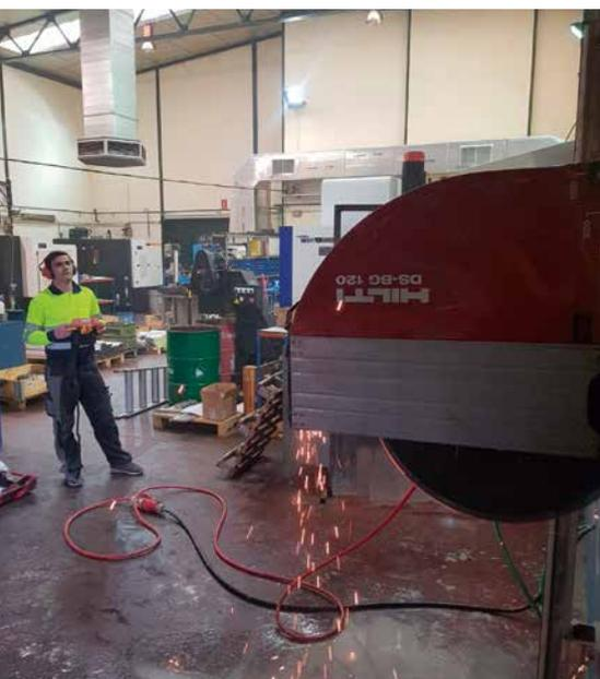
La cortamuros Hilti DST 20-CA sólo se compone de una cabeza de sierra para cortar hasta disco de 1600 mm.
