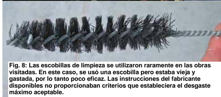
**Fig. 8: Las escobillas de limpieza se utilizaron raramente en las obras visitadas. En este caso, se usó una escobilla pero estaba vieja y gastada, por lo tanto poco eficaz. Las instrucciones del fabricante disponibles no proporcionaban criterios que estableciera el desgaste máximo aceptable.**
