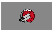
**Rellene con lana mineral.** Deje suficiente profundidad para aplicar CFS-IS.
