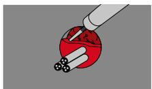
**Aplique el CFS-IS.** Aplíquelo en la profundidad requerida para obtener el grado de resistencia al fuego deseado, asegurándose de que el CFS-IS está en contacto con toda la superficie a sellar, para garantizar la máxima adherencia.
