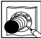
Aplicar CFS-S ACR utilizando un dosificador. CFS-S ACR adhiere correctamente sobre la mayoría de sustratos (hormigón, mampostería, tabique seco, yeso, etc.), sin necesidad de usar un imprimador. Para una mejor adherencia sobre superficies porosas, utilice el propio CFS-S ACR diluido en agua como imprimador. No son necesarios otros imprimadores.
