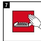
La espuma se puede moldear o alisar con la mano (si fuera necesario) después de aprox. 5 minutos (a 23°C). ¡Utilice guantes de protección! Después de aproximadamente 10 minutos (a 23°C) la espuma se endurecerá y entonces podrá cortarse.
