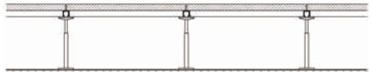
Construcción estándar de suelo técnico con estructura de apoyo (zonas no sísmicas).
