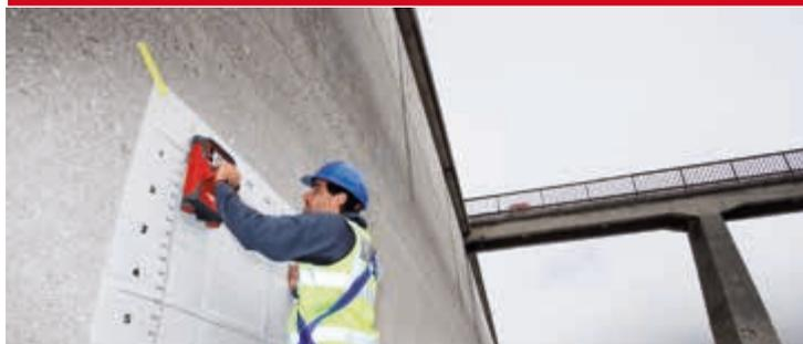
PS 250 y PS 1000 - Sistema completo, compacto y sin cable de uso rápido, flexible y simple para detectar el armado y no dañarlo durante el taladrado.
