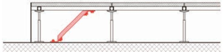
Zonas sísmicas: Arriostramiento de suelos técnicos en los extremos sin muro tope.
