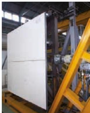
La fachada ventilada presenta riesgo de caída en caso de terremoto. La normativa francesa define un método de ensayo sísmico para el sistema completo.
